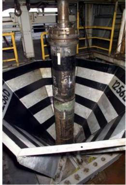
Photographie de l'axe rotatif du forage vu du pont du navire (à gauche) et adaptation de la colonne de forage sur le cône qui permet de la recentrer au fond de l'océan (à plus de 3 500 m de profondeur) pour une pénétration perpendiculaire au sein des roches.
