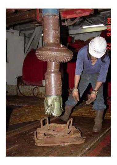
Le système de perforation des roches : 3 têtes munies de multiples dents broient la roche en découpant au centre un cylindre rocheux (carotte) qui remonte progressivement dans le tube.
