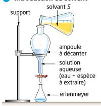
Fermer le robinet de l'ampoule à décanter et placer un récipient collecteur en dessous (erlenmeyer ou bécher).
