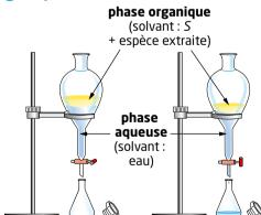
Replacer l'ampoule sur son support et retirer le bouchon. Deux phases liquides se séparent. Le solvant qui a la plus grande masse volumique est situé sous l'autre solvant. Récupérer la phase la plus dense dans un erlenmeyer en ouvrant le robinet, puis en le fermant avant que l'autre solvant ne coule. Récupérer l'autre phase dans un autre récipient en ouvrant de nouveau le robinet.
