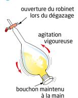
Agiter vigoureusement l'ensemble. De temps en temps, dégazer en ouvrant le robinet et en maintenant l'ampoule à décanter la tête en bas. L'espèce à extraire initialement dans le mélange aqueux est alors transférée dans le solvant d'extraction S.
