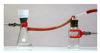
Dispositif pour filtration sous pression réduite : entonnoir Büchner, fiole à vide et fiole de garde reliée à une trompe à eau ou une pompe.
