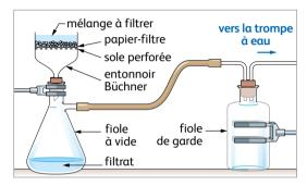
La trompe à eau ou la pompe crée une aspiration qui accélère le passage du liquide à travers le filtre.
