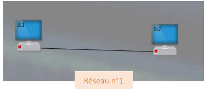
**1.4.** Lancer la première simulation, mais pour mieux suivre, sélectionner d'abord une vitesse lente, grâce à l'icône « vitesse ». Sélectionner alors la première station par un clic sur le bouton droit : « émettre une trame Ethernet ».
