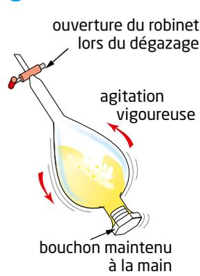
Agiter vigoureusement l'ensemble. De temps en temps, dégazer en ouvrant le robinet et en maintenant l'ampoule à décanter la tête en bas. L'espèce à extraire initialement dans le mélange aqueux est alors transférée dans le solvant d'extraction  $S$ .
